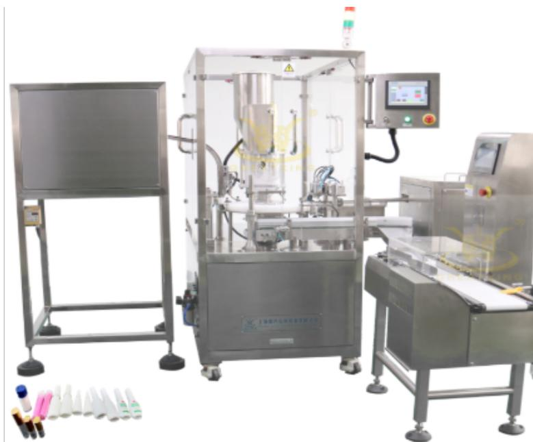
中文名灌装旋盖机外文名SCREWINGCAPPINGMACHINE灌装量5—30毫升生产能力2200瓶/时目录1英文名称2技术参数3调节方法4使用须知5安装注意灌装旋盖机英文名称编辑英文名称SCREWINGCAPPINGMACHINE灌装旋盖机技术参数编辑灌装量5—30毫升生产能力2200瓶/时电机规格380伏50赫兹、370瓦、1400转/分外形尺寸126×67×151（公分）设备重量110千克—140千克功能范围灌液、落盖加锁口一次完成灌装旋盖机调节方法编辑1、进料半的调节a将进料半上的拦瓶板A向上调节，使适应进瓶行程缩短；向下调节，使适应进瓶行程延长b左右调节定位瓶位
